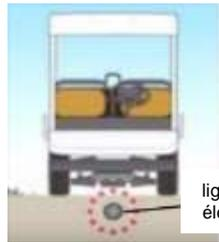
ligne d'induction électromagnétique
